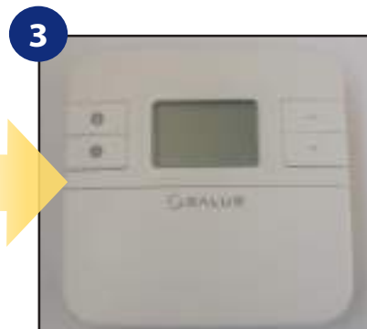
3 Namontujte přední kryt. Lehce stiskněte.
